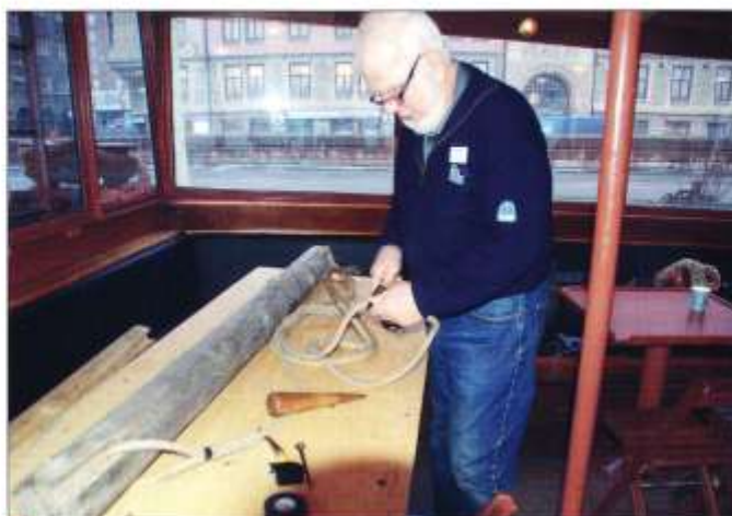
Fortfarande finns sjömaning eller sjömansarbete ombord. Här splitsar Bengt Boge linorna till en av fröbultarna. Dessa lever ett hårt liv och får sitta emellan vid hårda tilläggningar. Foto Bo Starmark 16/2 2017.
